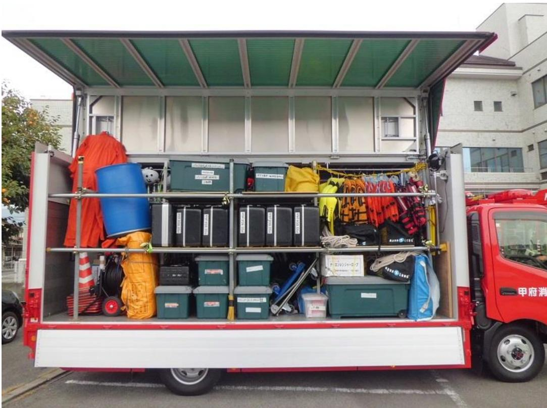
後部は、電動上部跳ね上げ式扉及びアームリフター（積載量 1,000kg）
