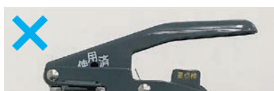
安全栓が外れている状態
