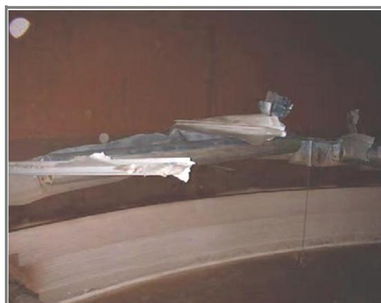
スロッシングにより破損したタンク
